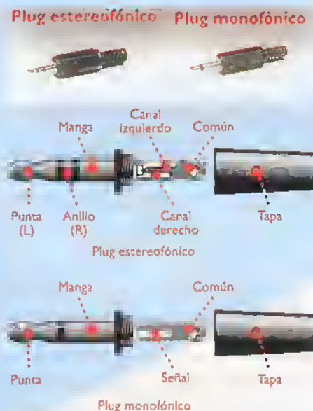
Figura 3.26. Estructuras de un plug monofónico y de un plug estereofónico
